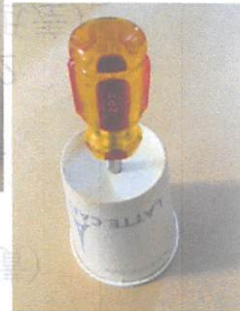
1b, 底の穴を直径6mmに加工
