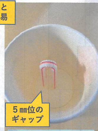
1d, カップの底から5mm位ストローの端が上方に
