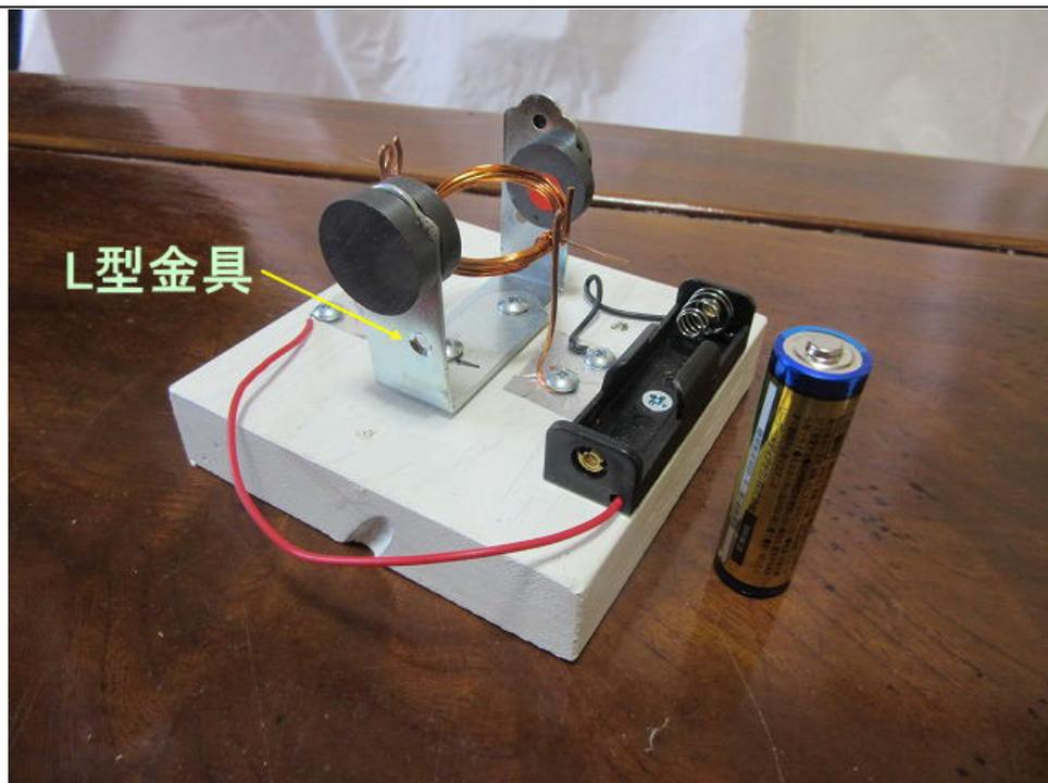
従来のクリップモータはロータの下にフェライト円盤磁石を置いただけなので磁界が空間に作られており、磁界が弱かった。そこで L 型の鉄製金具でコの字磁気回路を作った結果、磁界が強くなりパワフルに回転させることができるようになった。
