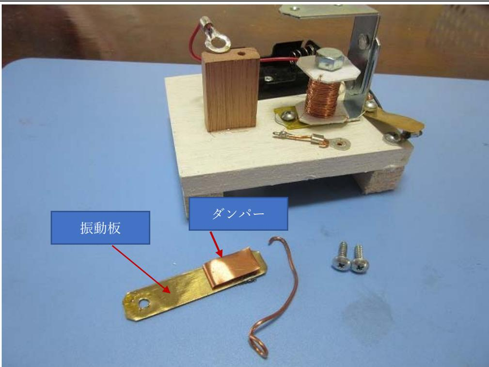
振動板は 0.2mm 厚の真鍮板を用い、その上に 0.1mm 厚の銅板を折り返したダンパーとして振動板先端にはんだ付けします。ダンパー反対面には鉄片を接着してあります。
