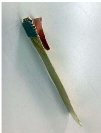
また振動板は写真のように、ベースの真鍮板、ダンパーを銅板としてはんだ付けし、磁気片を振動板の先端に接着した。参加者からはやはりヨークの効果を疑問視する声があり、さらに改良を試みることになった。
