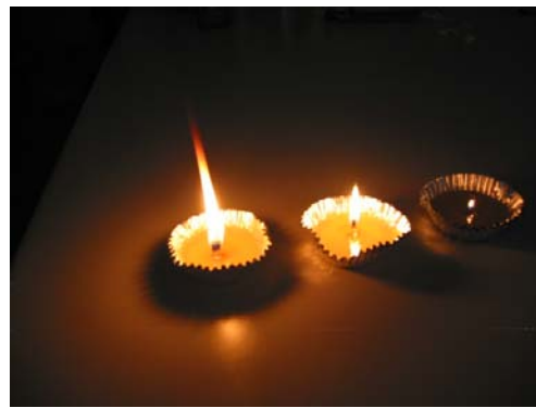
凝固後 芯の太さ比較
