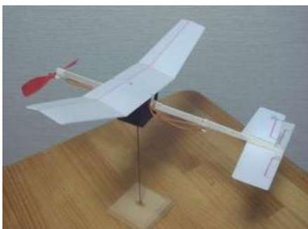
製作は簡単で、プロペラ径100mm、軸受、フックなどは市販樹脂製のセットを使用し、約10mm程度の翼台を取り付け安定性を向上させ、接着は5mm幅両面テープで手を汚さず組み立てられるようにした。
