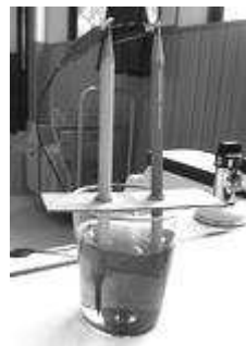
紫キャベツ液の酸性アルカリ性 反応(右)と電気分解(左)の実験
